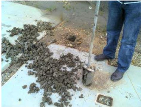
Photo 3 - Sondage à la tarière manuelle dans la zone de rétention de S10
