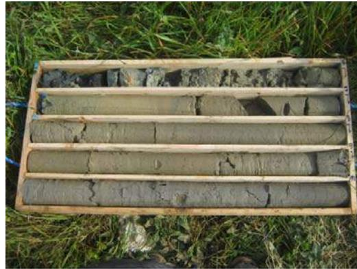
Photos 6 et 7 - Caisses à carottes prélevées à partir du sondage réalisé au droit de PZ-23
