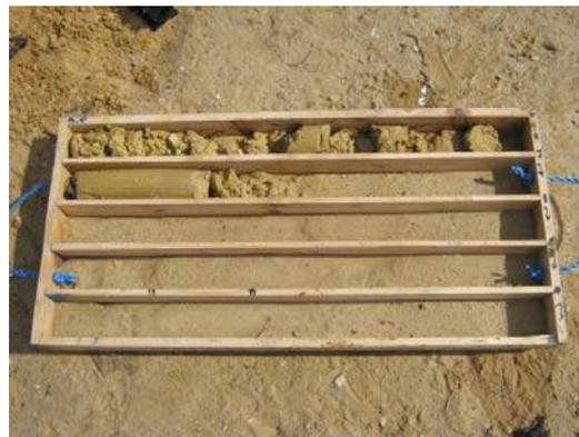
Photos 10 & 11 - Caisnes à carottes prélevées à partir du sondage réalisé au droit de PZ-25
